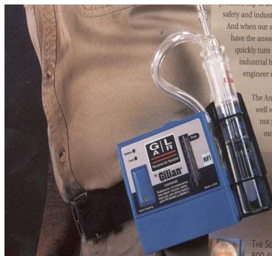
Fig.4. Sistem de prelevare pentru poluanți gazoși în emisie și imisie
