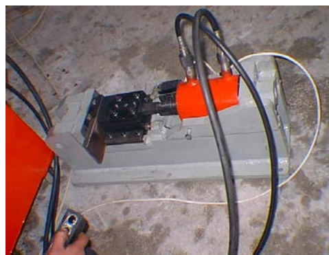
Fig.3. Presa hidraulică orizontală de 400 kN
