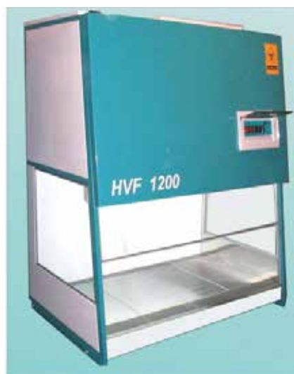
Fig. 2 Hota microbiologică cu flux laminare vertical
