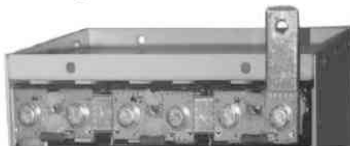
Figura 5. Baterie de supercondensatoare cu modul de egalizare activă
