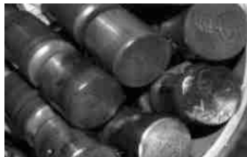
Fig.3. Detaliu capete pistonașe ovalizate
