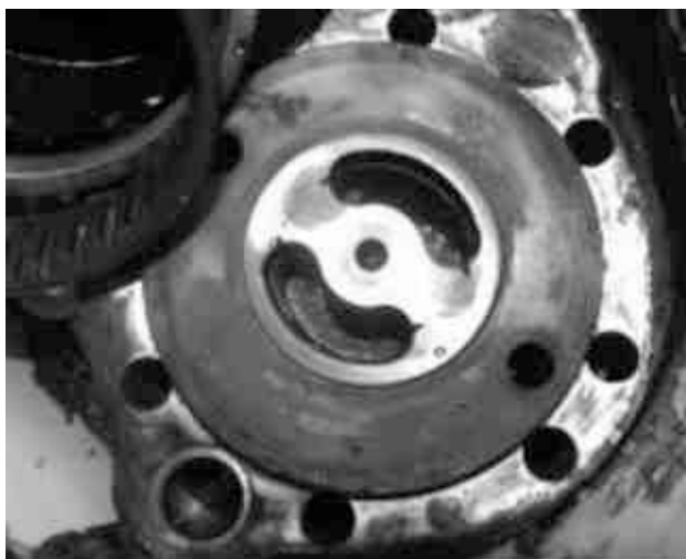
Fig.1. Discul de distribuție al pompei cu pistoanașe axiale demontat
