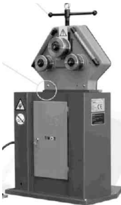
Fig.2: Masina de indoit profile echivalent bara rotunda 15...30, cu actionare electromecanica a rotelor si reglaj manual.
