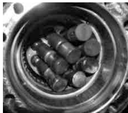
Fig.4. Pistonașe cu cuplaj sferic (aspect la demontare)
