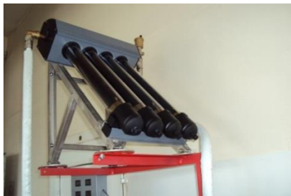
Fig. 4. Mini solar thermal panel
